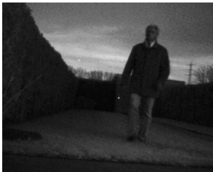
Bild 3: Airglow-Beleuchtung genügte für diese Aufnahme in mondloser, sternklarer Nacht mit empfindlicher SWIR-Kamera
