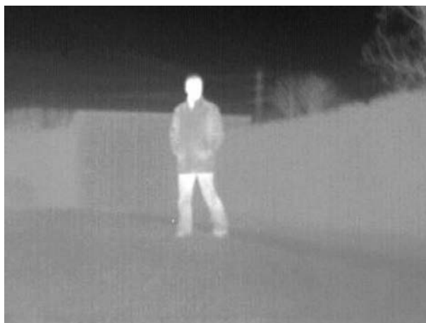
Bild 6: Die thermische Abbildung einer ungekühlten Mikrobolometer-Kamera kann VISWIR-Bilder um selbststrahlende Objekte vorteilhaft ergänzen
